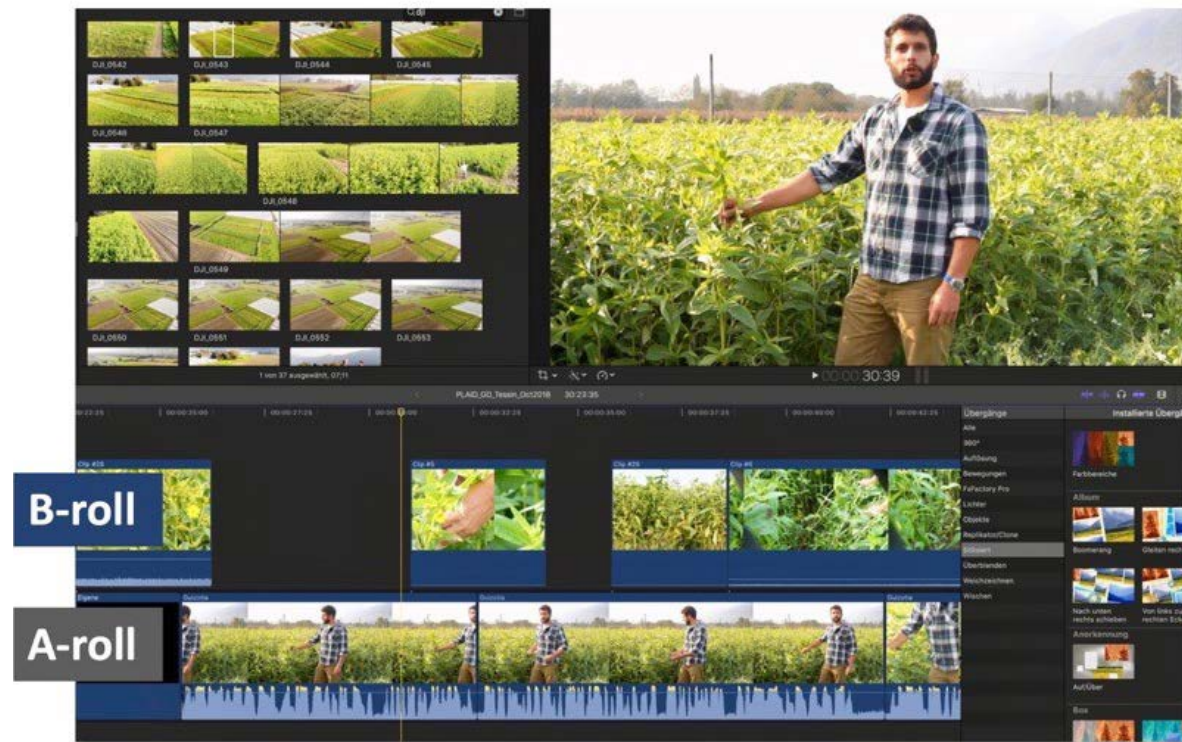
Abbildung 16. Anordnung von A- und B-Roll im Bearbeitungsprogramm. Bilder der B-Roll werden verwendet, um Schnitte in der A-Roll zu überdecken und um visuell zu unterstützen, was in der A-Roll kommentiert wurde. (Quelle: Deliverable 4.3-PLAID)
