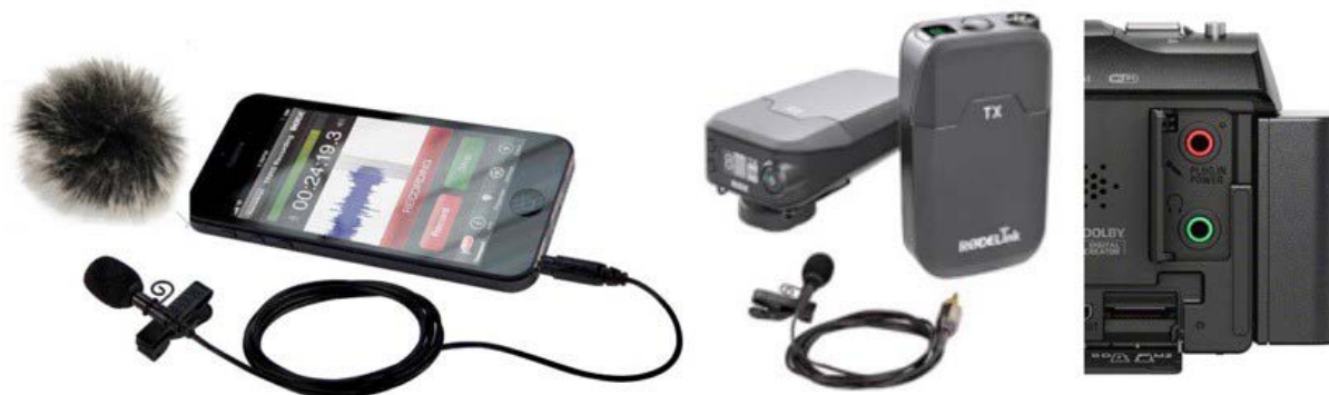
Figure 11. À gauche : des microphones simples avec câbles pour smartphones sont disponibles à partir de 20 euros. Au centre : le lien radio RodeLink offre un bon rapport qualité-prix. À droite : lors de l'achat d'une caméra vidéo, assurez-vous qu'il y a des connexions pour le microphone (prise rouge) et les écouteurs (prise verte). (Source : Deliverable 4.3-PLAID)
