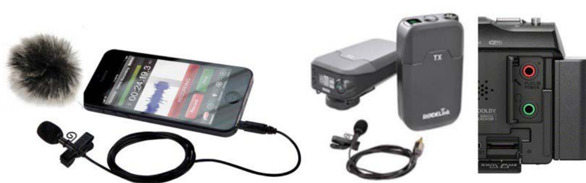
Σχήμα 11. Αριστερά: απλά μικρόφωνα με καλώδια, για smartphone, είναι ήδη διαθέσιμα από 20€ και πάνω. Μέση: η ραδιοζεύξη RodeLink προσφέρει μια καλή αναλογία τιμής/απόδοσης. Δεξιά: όταν αγοράζετε μια βιντεοκάμερα, βεβαιωθείτε ότι υπάρχουν είσοδοι για μικρόφωνο (κόκκινη θύρα) και ακουστικά (πράσινη θύρα). (πηγή: Παραδοτέο 4.3-PLAID)
