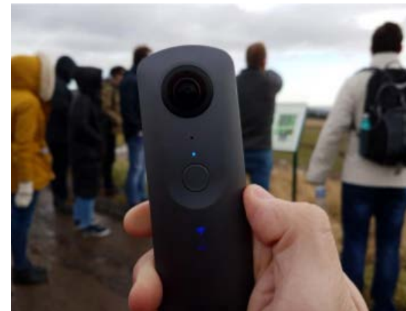
Joonis 9. Ricoh Theta V 360° kaamera (allikas: Deliverable 4.3-PLAID)
